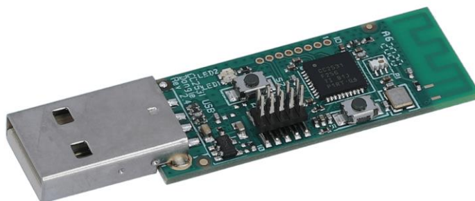
Obrázek 4 USB analyzátor packetů s CC2531 [29]
