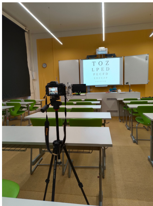
Obrázek 5.14. Ukázka nastavení měření pomocí jasového analyzátoru
