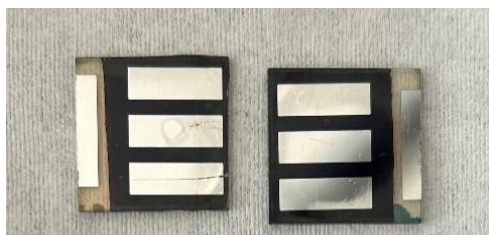
Obrázek 5.3 Ukázka perovskitového článku
