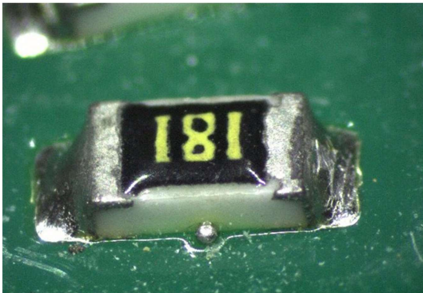
Obrázek 12: Ukázka kuličky pájky po přetavení [52].
