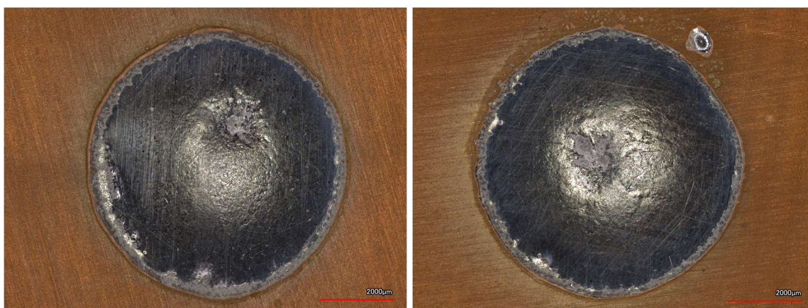
Obrázek 28: Snímky přetavené pájecí pasty pořízené konfokálním mikroskopem. Vlevo starší pájecí pasta na měděném substrátu, vpravo novější pájecí pasta na měděném substrátu ošetřeném OSP.
