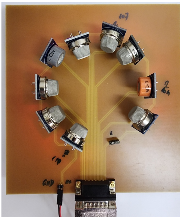
Obrázek 27: Zapojení matice senzorů plynu s použitím plošného spoje.
