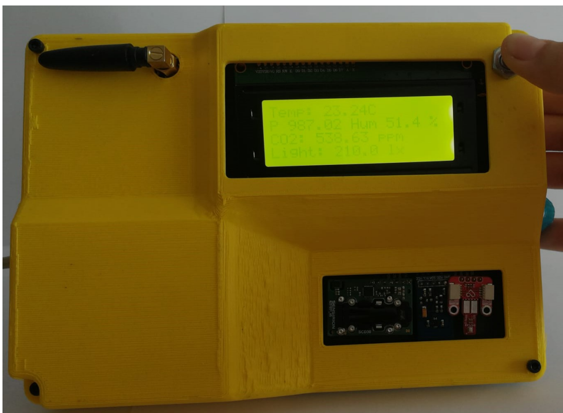
Obrázek 10.1. Finální navržené a realizované zařízení pro kontinuální měření parametrů vnitřního prostředí
