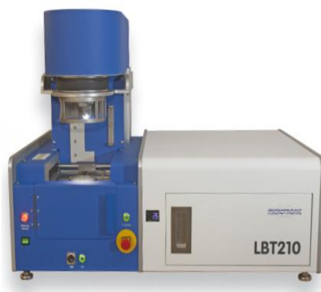
Obrázek 30 Meniskograf Microtronik LBT 210, stejný typ byl využit při experimentu. [58]
