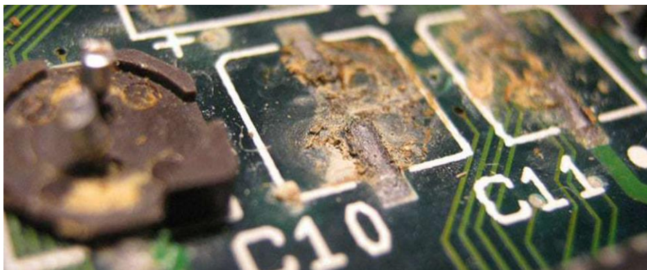
Obrázek 17 Ilustrativní obrázek koroze na DPS [28].
