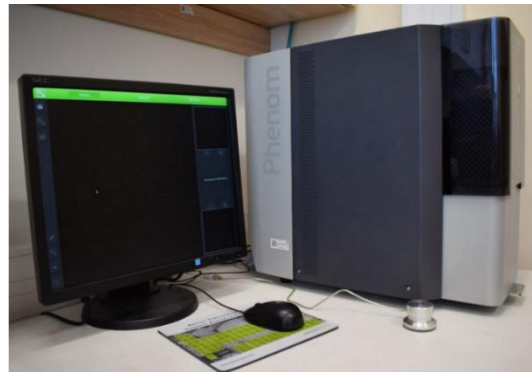
Obrázek 28 Skenovací elektronový mikroskop Phenom. [57]
