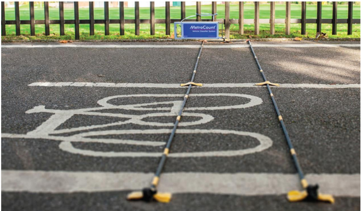
Obr. 3 Příklad pneumatického detektoru na cyklostezce [6]
