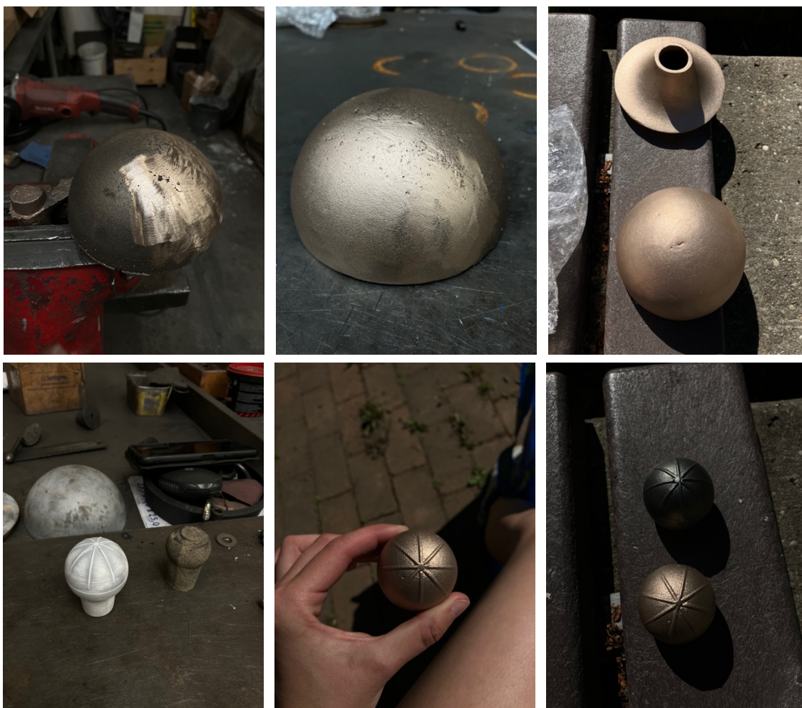
Obr 80–85: Výsledky odlévání z bronzu, a test povrchové úpravy, fakulta strojní na ČVUT
