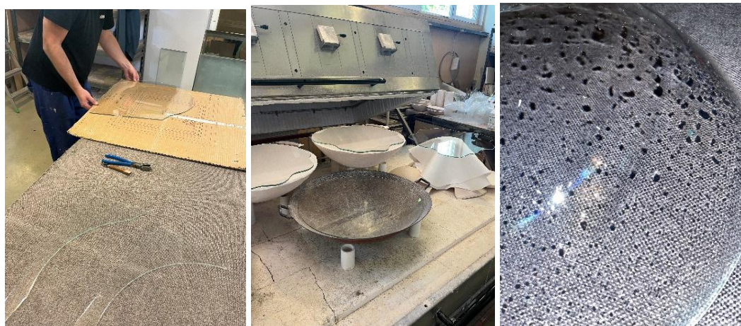
Obrázok 38-40: proces výroby líhaného skla
