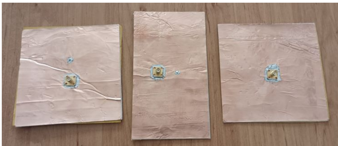
Obrázek 5.2: Hotové aplikátory ze strany zemnicí roviny
