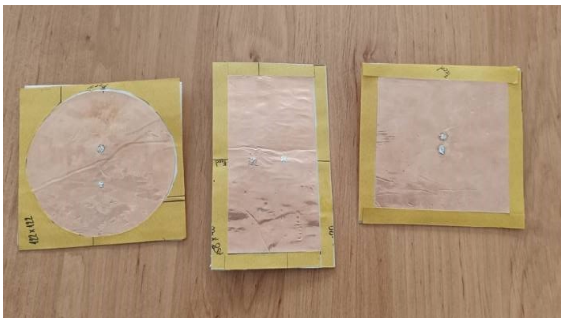
Obrázek 5.3: Hotové aplikátory ze strany anténního prvku
