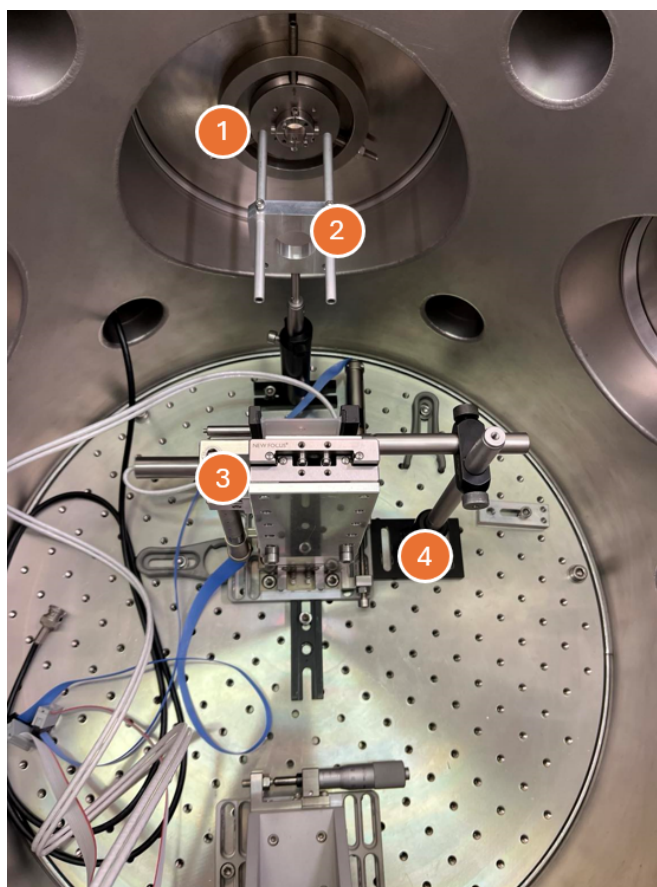
Obrázek 2.6: Pohled do interakční komory: 1 - vstupní apertura se záměrným křížem, 2 - držák filtrů, 3 - x-y-z posuvné stolky, 4 - držák.
