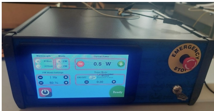
Obr. 32 – Laser „Pomalas“ umožňuje produkovat laserové záření o vlnové délce 915 nebo 1470 nm
