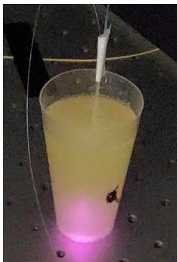
Obr. 49 – Nádoba naplněná tekutým albumen, vertikální laserové vlákno a 2 kolmá senzorká vlákna
