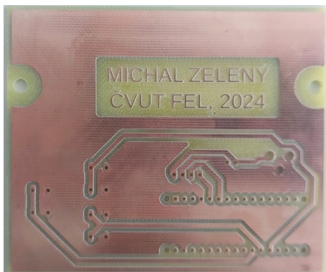
Obr. 23 – Vyfrézovaná deska plošných spojů
