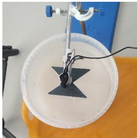
Obrázek 3.19 – vodní bolus vytvořený zalitím fantomu vodou do výšky 8 cm
