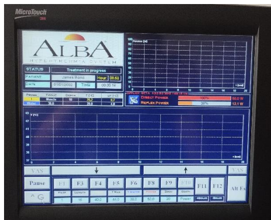
Obrázek 3.23 – zkušební měření hypertermické soustavy ALBA pro vodní bolus tvořený plastovým polštář
