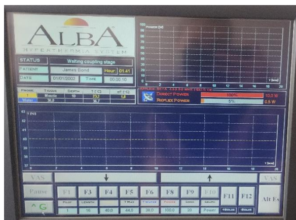
Obrázek 3.24 – zkušební měření hypertermické soustavy ALBA pro vodní bolus vytvořením zalitím fantomu vodou
