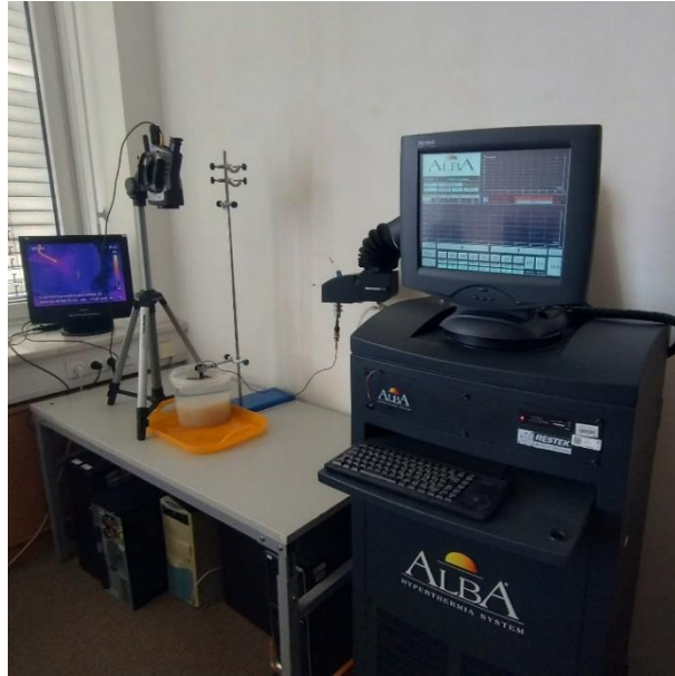
Obrázek 3.22 – soustava pro výsledné měření teplotního rozložení pomocí termokamery
