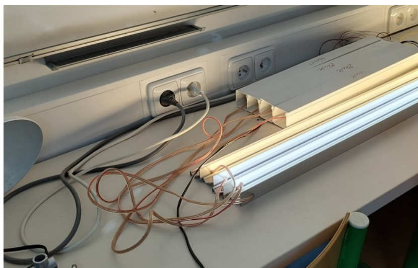
Obr. 6.7: LED panely, ktoré sme využívali pri testovaní riadiacich jednotiek.
