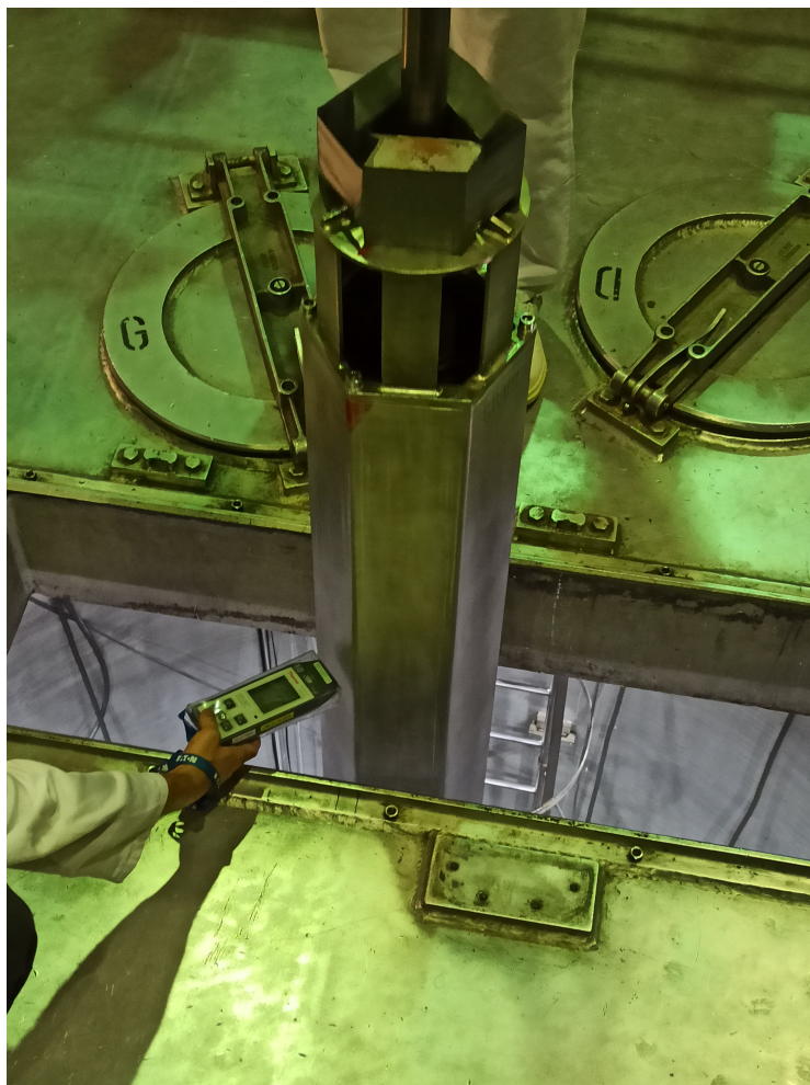
Obrázek 4.4: Vyzdvihování suchého kanálu u reaktoru LR-0 po ukončení ozařování.
