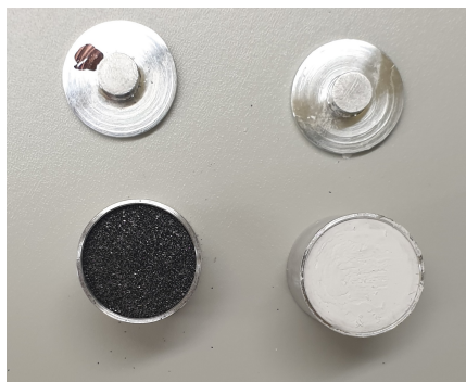
Obrázek 4.1: Hliníková pouzdra naplněná práškem \text{B}_4\text{C} (vlevo) a \text{LiF} (vpravo).
