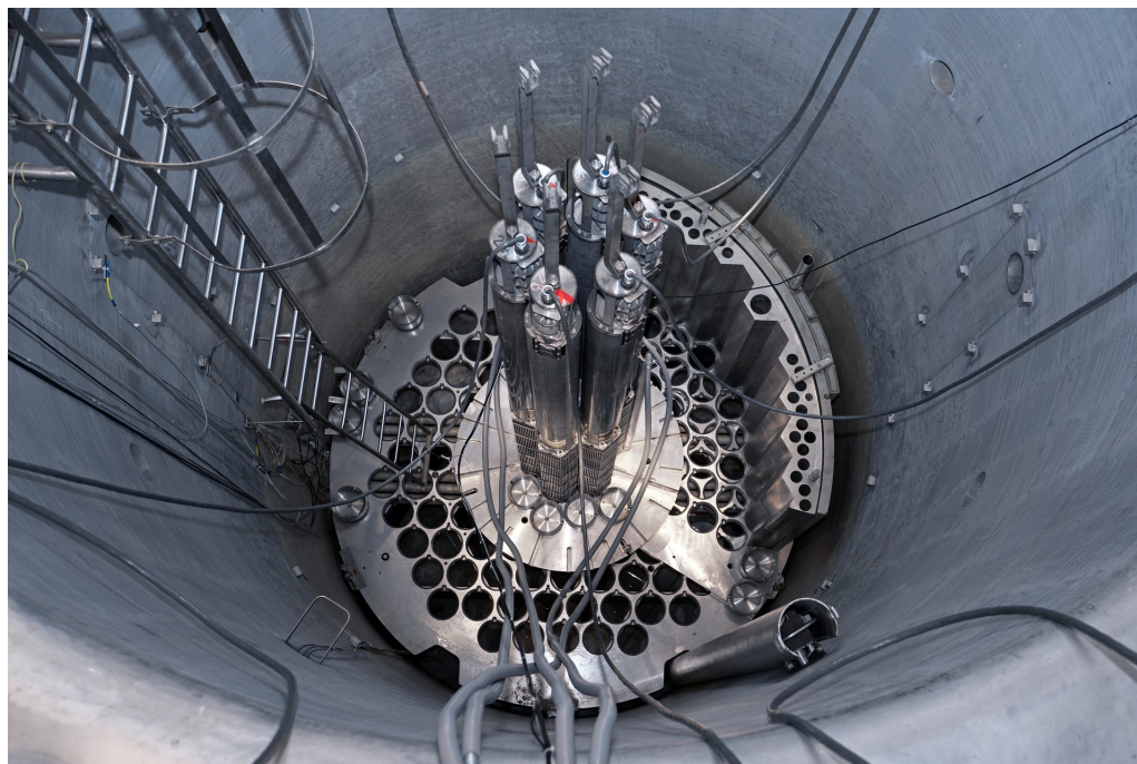
Obrázek 3.1: Speciální konfigurace AZ reaktoru LR-0 použité při experimentu v kapitole 4.
