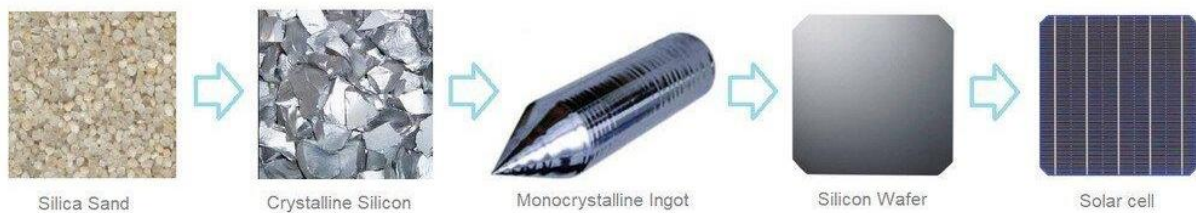
OBRÁZEK: 21 PROCES VÝROBY FOTOVOLTAICKÉHO ČLÁNKU 59
