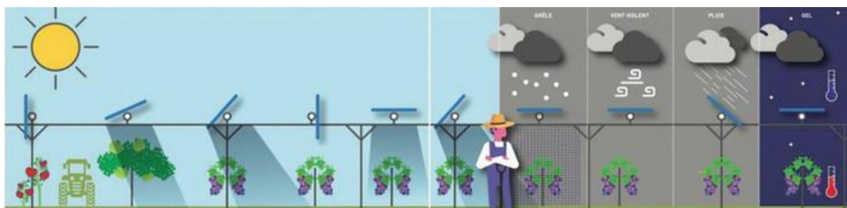
OBRÁZEK 32: MOŽNÉ ÚČINKY OCHRANY PLODIN PROSTŘEDNICTVÍM RŮZNÝCH ÚHLŮ AGROVOLTAICKÝCH SYSTÉMŮ 90
