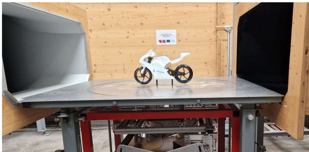
Obrázek 29 – Podmínky experimentu na aerodynamických vahách ve větrném tunelu
