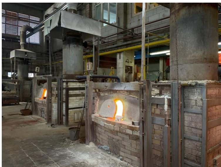
Obrázek 17: Sklářská pec ve sklárně Janštejn
