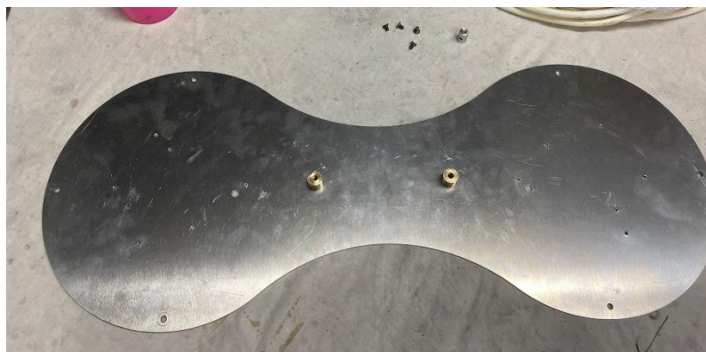
Obrázek 47: Plech + prostřední vystředovací díly se závitem
