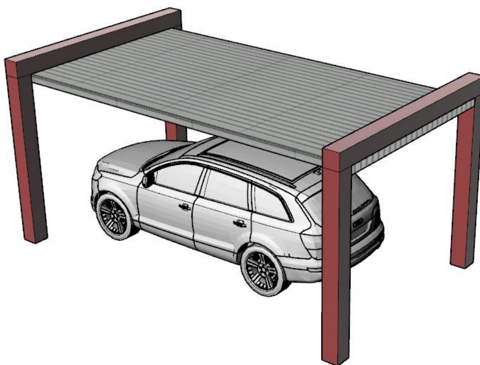
Obr. č. 35: Střecha s trapézovým plechem
