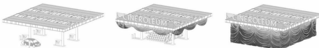
Fig. 4.2.2-03: Schéma principu fungování kina Cineroleum, dostupné z: https://www.archdaily.com/777156/the-cineroleum-assemble
