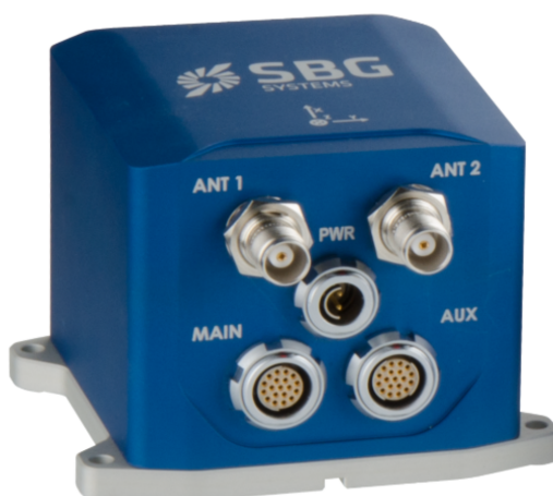
Obrázek 4.5. Profesionální INS Ekinox-D od SBG Systems [42]
