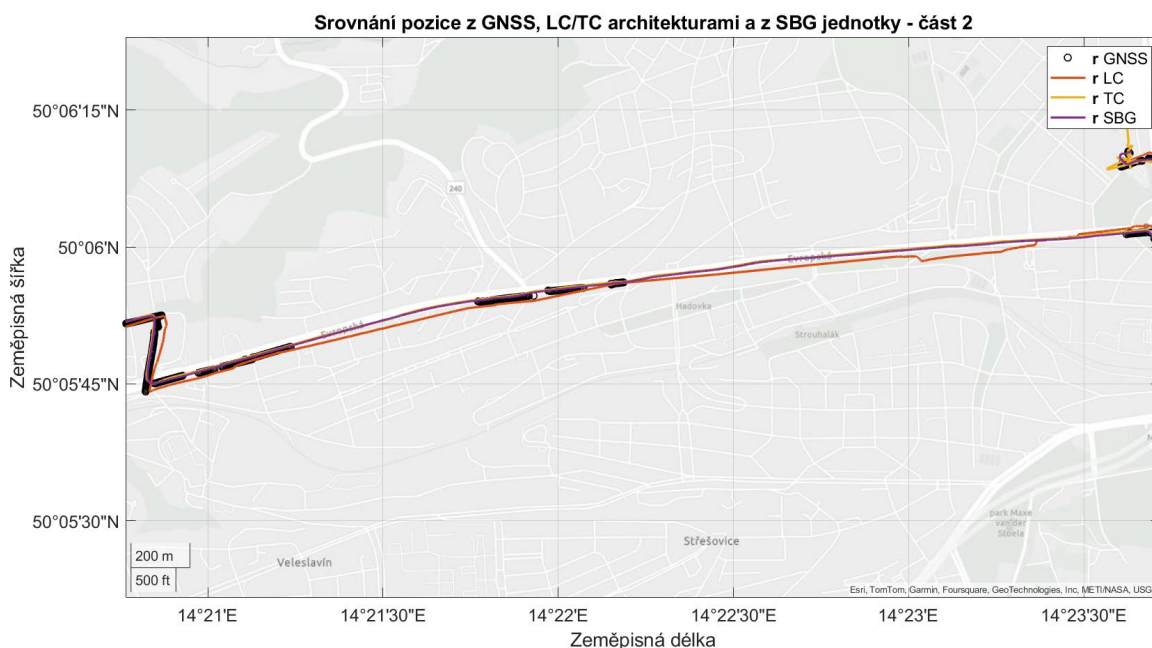
Obrázek 5.8. Srovnání výstupní pozice v mapě při jízdě širokou městskou ulicí. Zobrazena je pozice z volně vázaného systému (oranžová), z těsně vázaného systému (žlutá) a z referenční SBG jednotky (fialová). Mapa je také doplněna o zaznamenané LLA pozice z výstupu GNSS přijímače.
