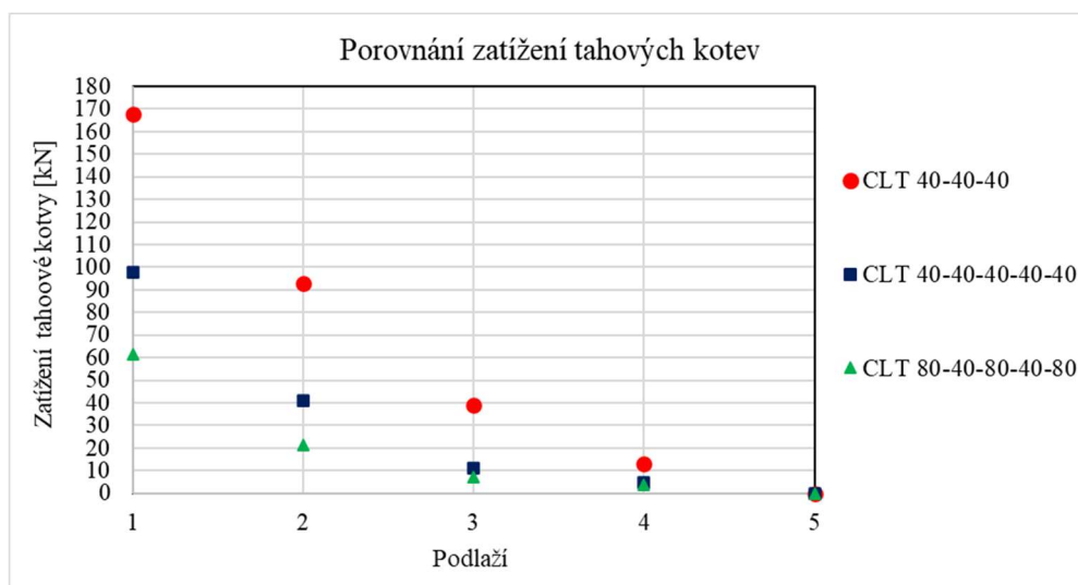
Obr. 4.6.1 V grafu jsou zaznamenány velikosti zatížení tahových kotev v jednotlivých patrech při různých tloušťkách stropních desek.
