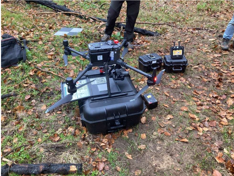
OBRÁZEK 17: RGB KAMERA PŘIPEVNĚNÁ K UAV DJI MATRICE 300 RTK
