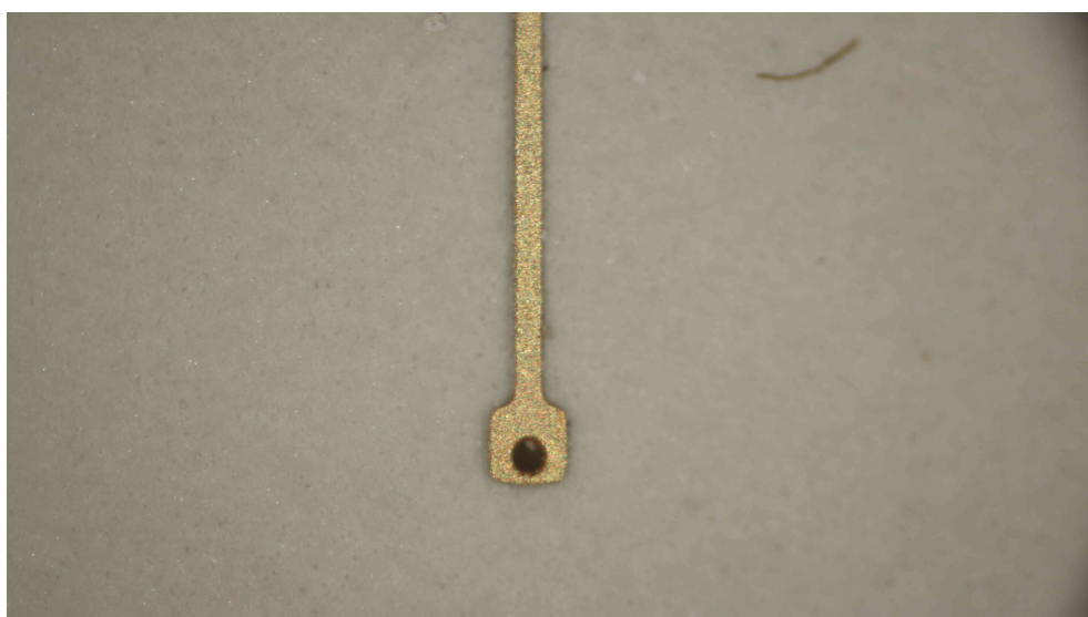
Obrázek 5.4: Vychýlení prokovu ze středu plošky
