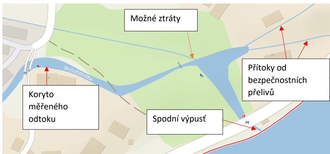
Obrázek 31: Detailní schéma odtoku z nádrže
