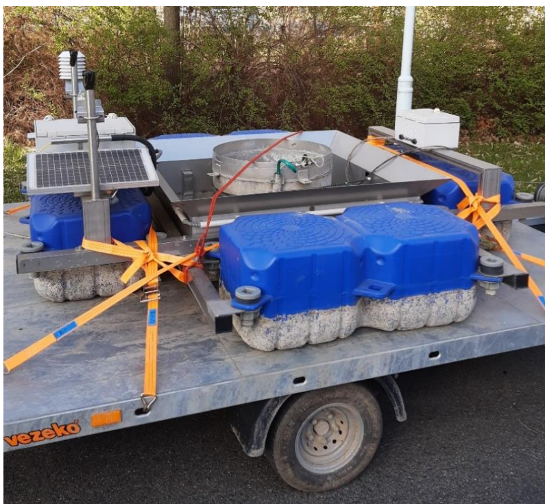
Obrázek 24: Plovoucí výparoměr při přepravě (Foto Ing. Petr Sklenář Ph.D.)
