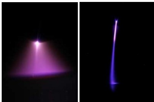
(a) záporný korónový výboj (b) kladný korónový výboj
