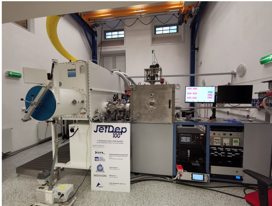
Obrázek 2.1: Fotografie depozičního clusteru JetDep100 na Katedře inženýrství pevných látek. Uprostřed se nachází komora JetDep100 a v levé části Glovebox, za kterým je umístěna aparatura ALD.
