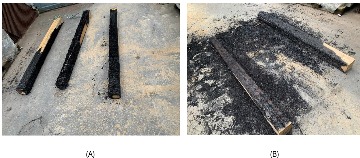
Obr. 4.8 (A) Sloupy se zuhelnatělou vrstvou; (B) Sloupy bez zuhelnatělé vrstvy
