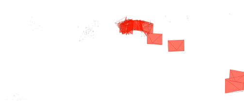
■ Obrázek 5.4 Vizualizace odhadnutých pozic kamer a extrahovaného sparse point cloudu pro dataset colmap-car4-phone.
