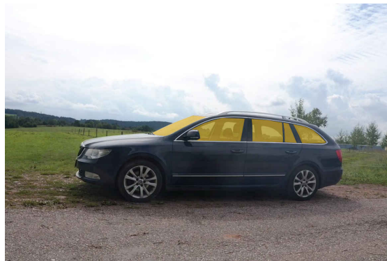
■ Obrázek 4.3 Snímek s anotovanými maskami skel. Anotace jsou reprezentovány vyplněnými žlutými polygony.
