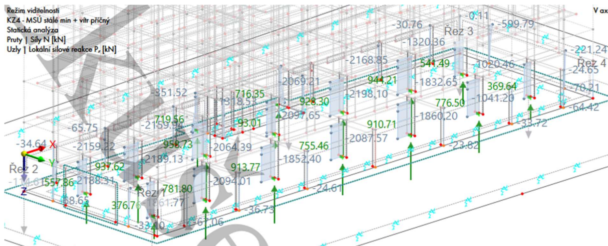
Obrázek 10 Normálové síly v pilířích
