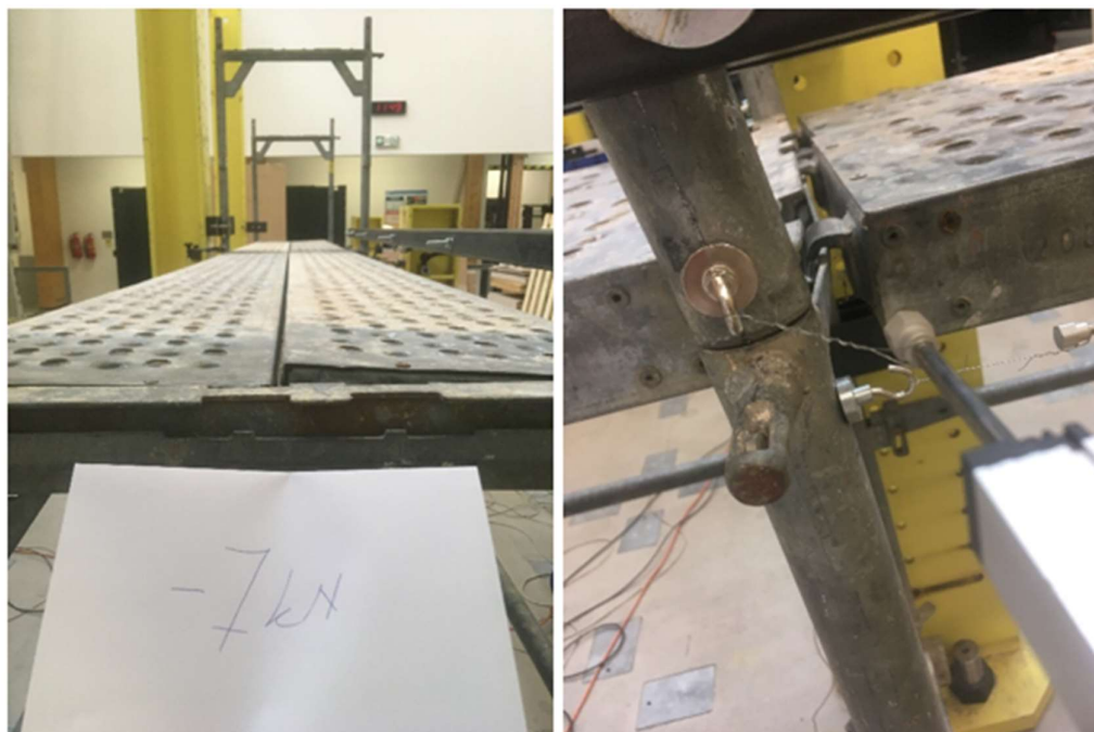
Obr. 32: Osmý zatěžovací cyklus, vpravo – deformace středního rámu.
