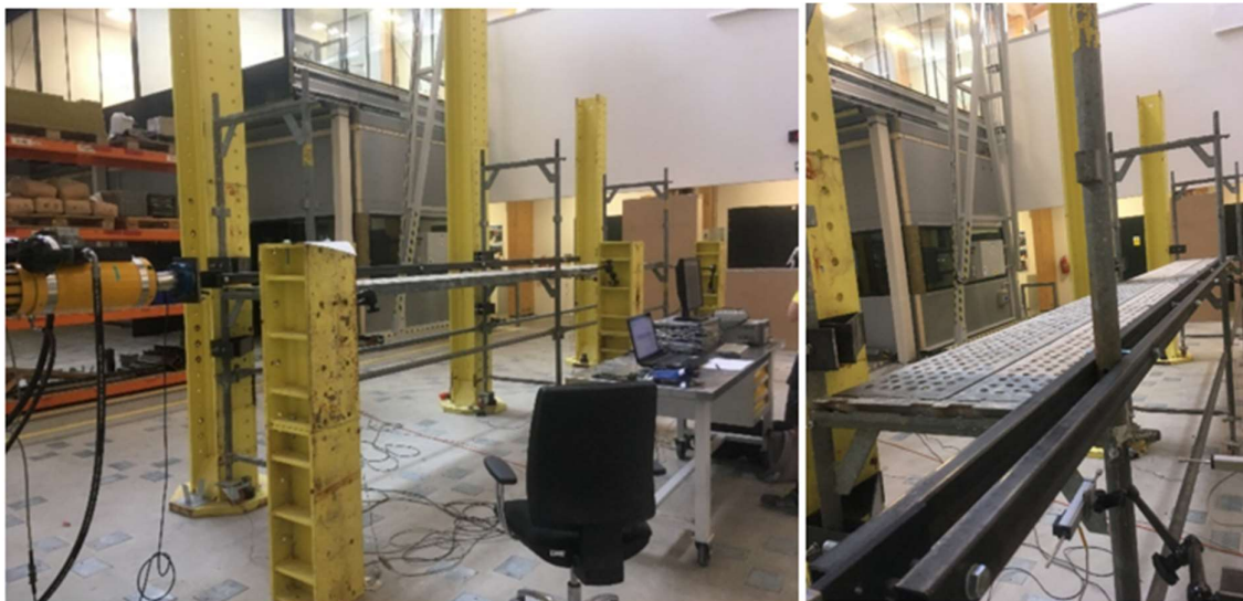
Obr. 31: Fotografie ze zkoušky tuhosti podlahy lešení rovnoběžně s fasádou.
