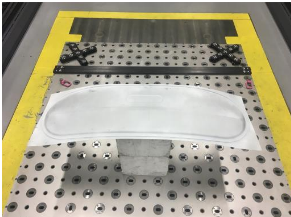
Obrázek 8-54, Měření rozměrů po tahové operaci, položení na polystyrenový blok
