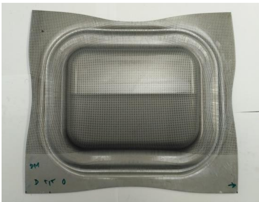
Obrázek 8-13, Výtažek z oceli DP500 s nanesenou deformační sítí
