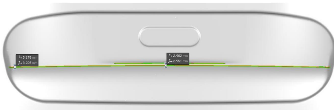
Obrázek 8-46, Bod 6, Riziko přetažené hrany při současném provedení
