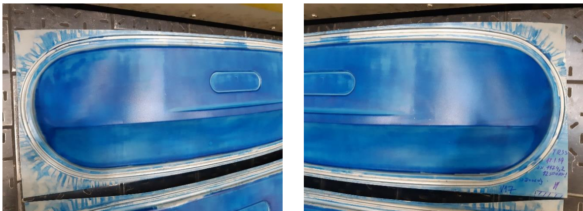
Obrázek 8-53, Tuširovací otisk v tažné operaci OP20
