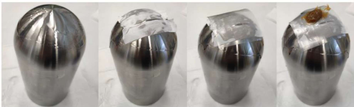
Obrázek 6.1 Postup aplikace jednotlivých částí tribologického systému [9A]
