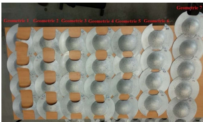
Obrázek 14.7 Zkušební vzorky po zkoušce dle Nakajimy
