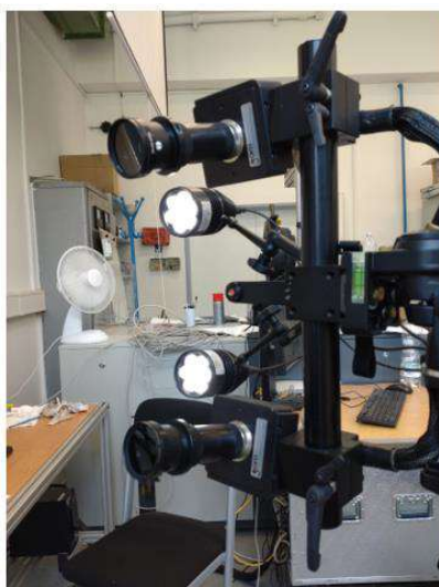
Obrázek 11.2: Optický snímací systém ARAMIS [1A]
