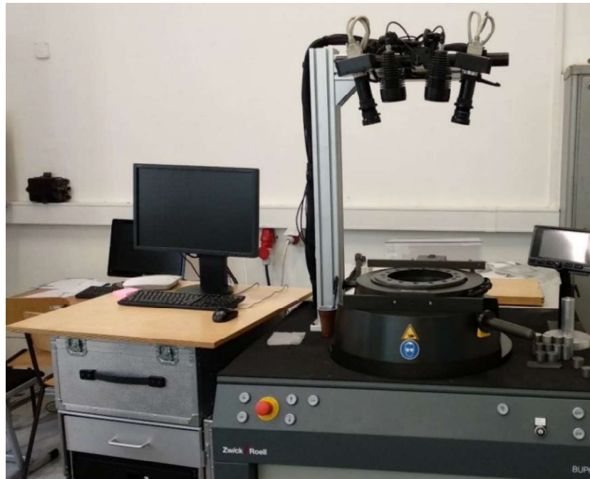
Obrázek 3.7 Schéma zkoušky podle Nakajimy (ČSN EN ISO 12004-2) s univerzálním testovacím stroje BUP600 a bezkontaktní měřícím systémem ARAMIS
