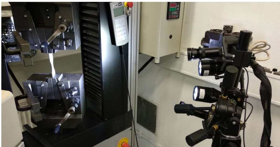
Obrázek 14.10 Uspořádání měřícího systému ARAMIS a zařízení pro tahovou zkoušku [14A]
