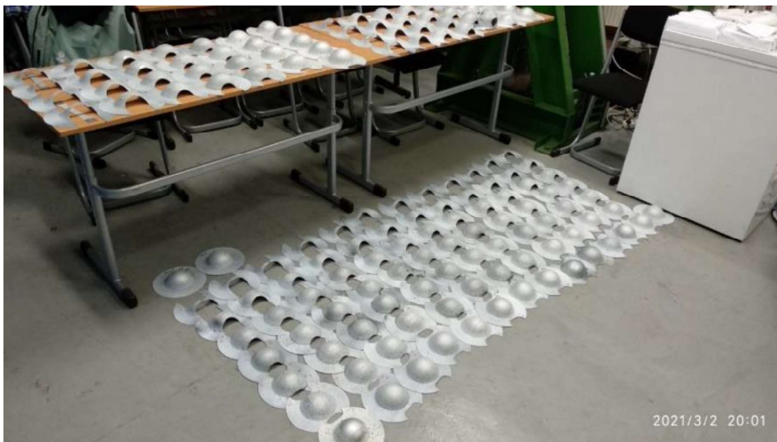
Obrázek 14.8 Zkušební vzorky po zkoušce dle Nakajimy pro šarže 1 až 5 materiálu DX57 (CR5)
