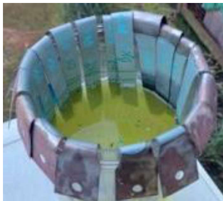
Obrázek 13.3 Odstranění povrchové úpravy vzorků v 10% roztoku HCl
