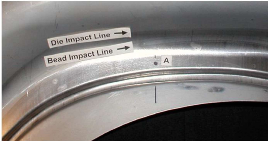
Obrázek 4.2 - Výlisek, který by dle konvenční FLC měl prasknout [9]
