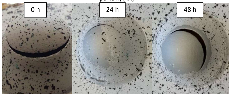
Obrázek 12.6 - Belton Universal Primer + Montana GRANIT (zleva: po uschnutí nástřiku; po 24 h; po 48 h) [4A]
