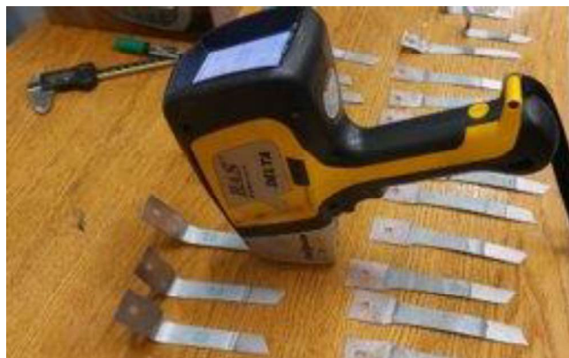
Obrázek 13.4 Průběh měření chemického složení
