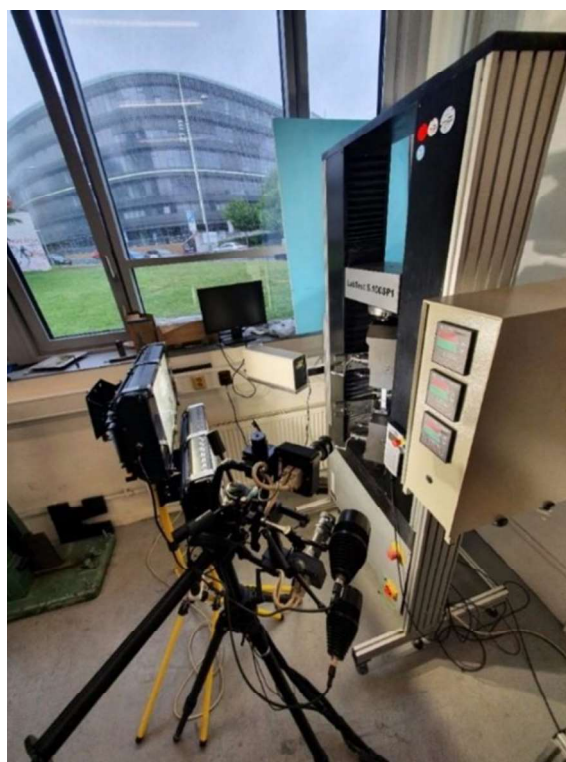
b) Rozestavení kamerového systému pro vyšší rychlosti
