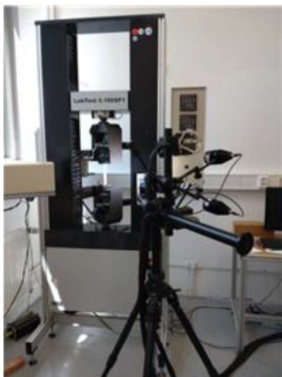
a) Rozestavení kamerového systému pro nižší rychlosti
