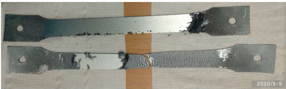
Obrázek 12.1 Vzorky pro zkoušku tahem s nesprávně provedeným postupem odmaštění [1A]
