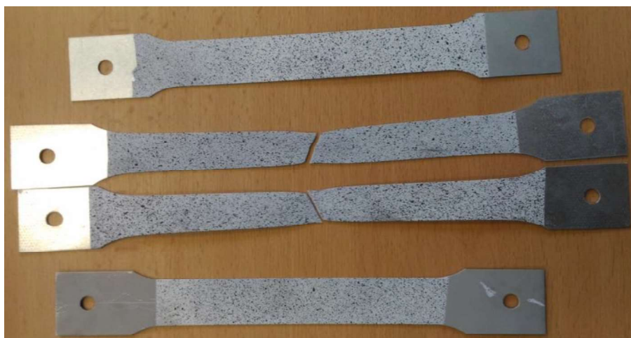
Obrázek 12.9 Pattern, který je tvořen bílou podkladovou barvou a černým matným nástřikem [1A]
