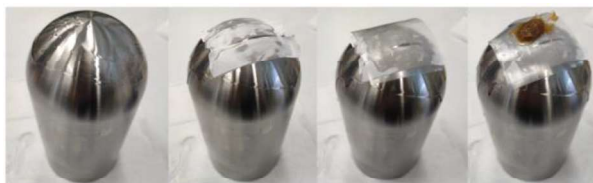
Obrázek 14.1 Postup aplikace jednotlivých částí tribologického systému
