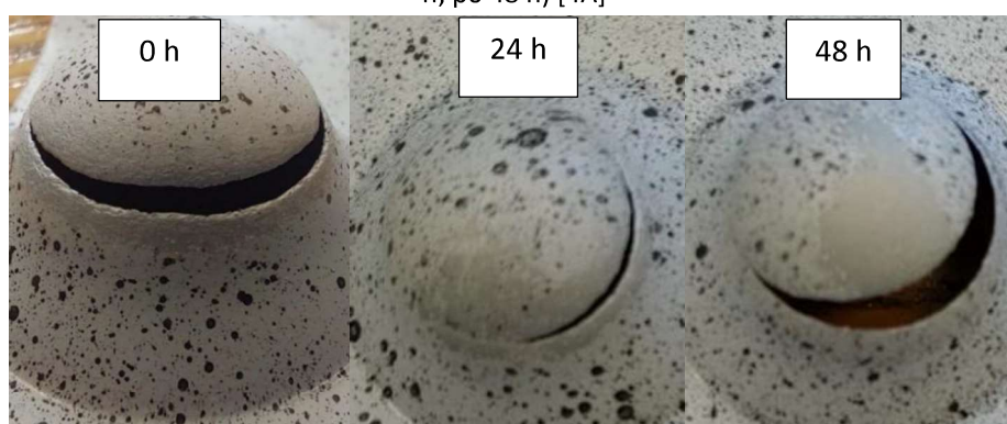
Obrázek 12.5 - Motip Matt White RAL 9010 + Motip Matt Black RAL 9005 (zleva: po uschnutí nástřiku; po 24 h; po 48 h) [4A]
