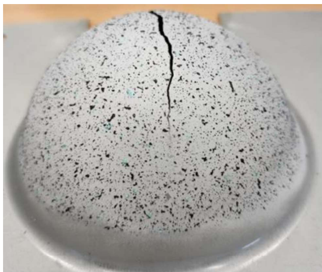
Obrázek 12.10: Možné výsledky zkoušky dle Nakajimy [4A]
