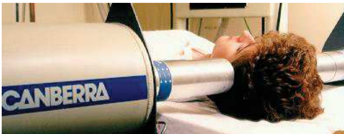
Obrázek 7 Geometrie měření aktivity v lebce – celotělový počítač SÚRO v Praze na Vinohradech před rekonstrukcí
