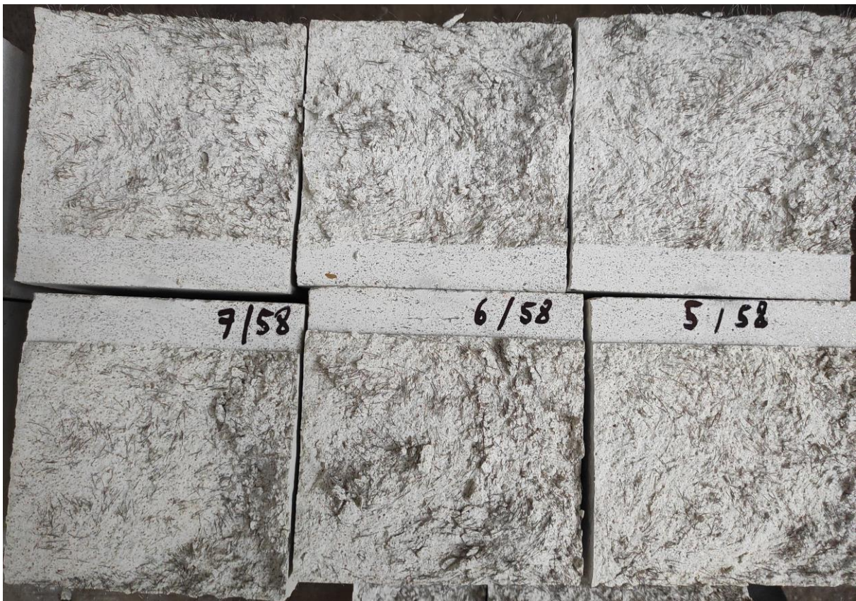
Obr. 65 Rozložení ocelových vláken v trámcích 100×100×400 mm po zkoušce v tahu za ohybu
