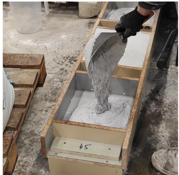
Obr. 63 Výroba první série vzorků z UHPFRC ( v_f = 1,5\% )
