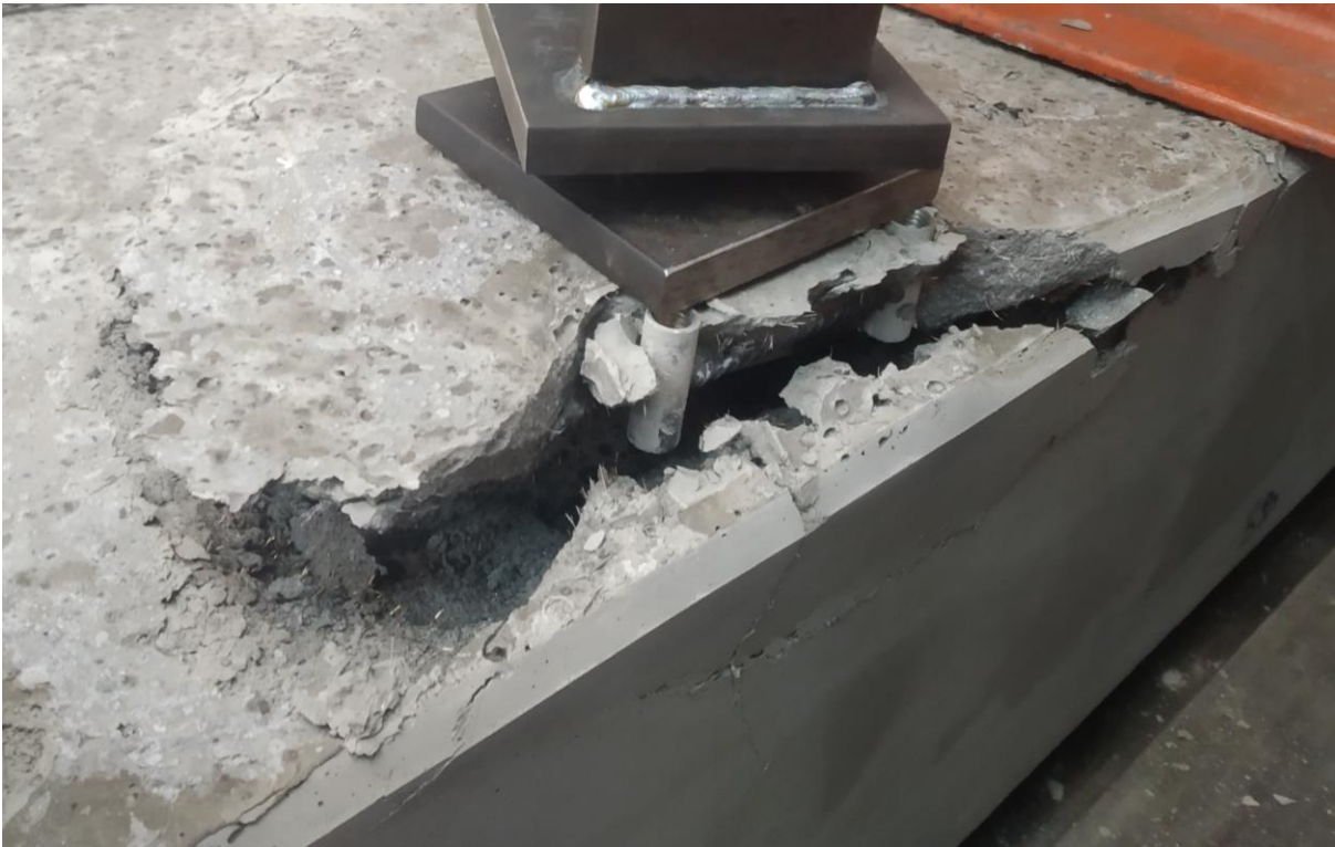
Obr. C-4 Porušení vzorku I'-Y-A
