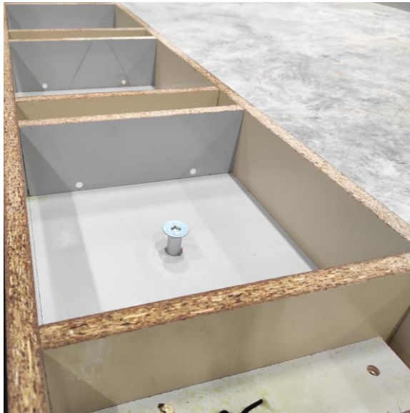
Obr. 62 Umístění kotvy na dně formy (F) a v horním povrchu (H)
