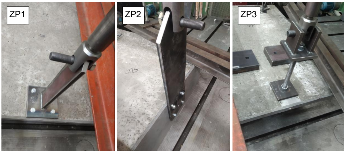
Obr. 99 Ocelové přípravky pro přenos zkušebního zatížení pro jednotlivé typy kotvení
