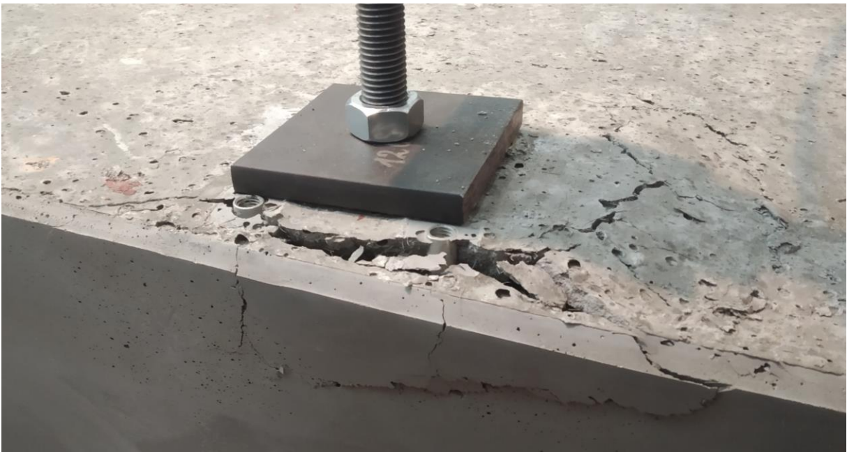
Obr. C-3 Porušení vzorku I'-Y-B
