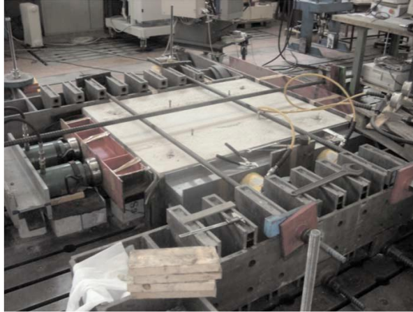
Obr. 31 Zkušební deska při stanovení vlivu předpětí na únosnost předem zabudovaných kotev v běžném betonu [49]
