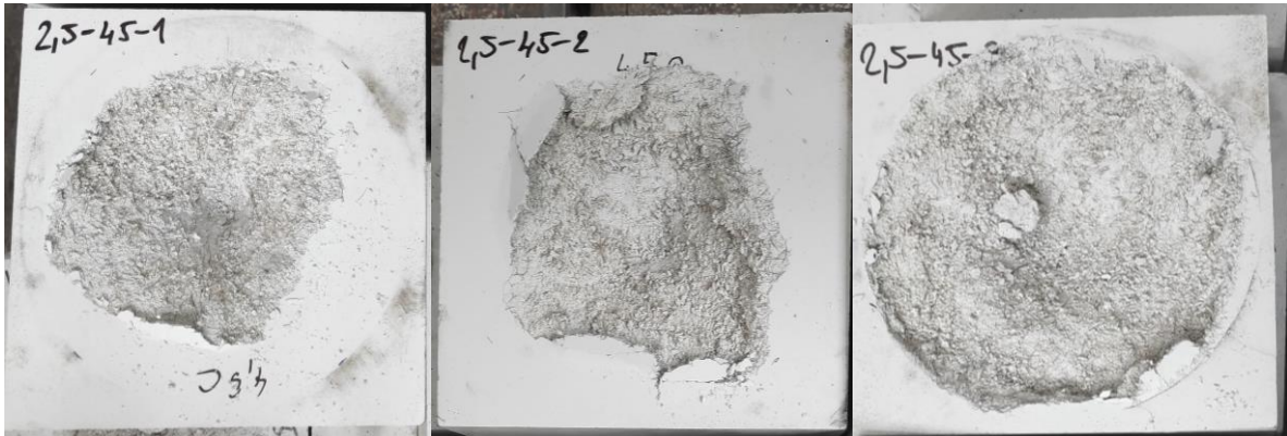
Obr. B-9 Tvar porušení vzorků série 2,5 %, h_{ef} = 45 mm
