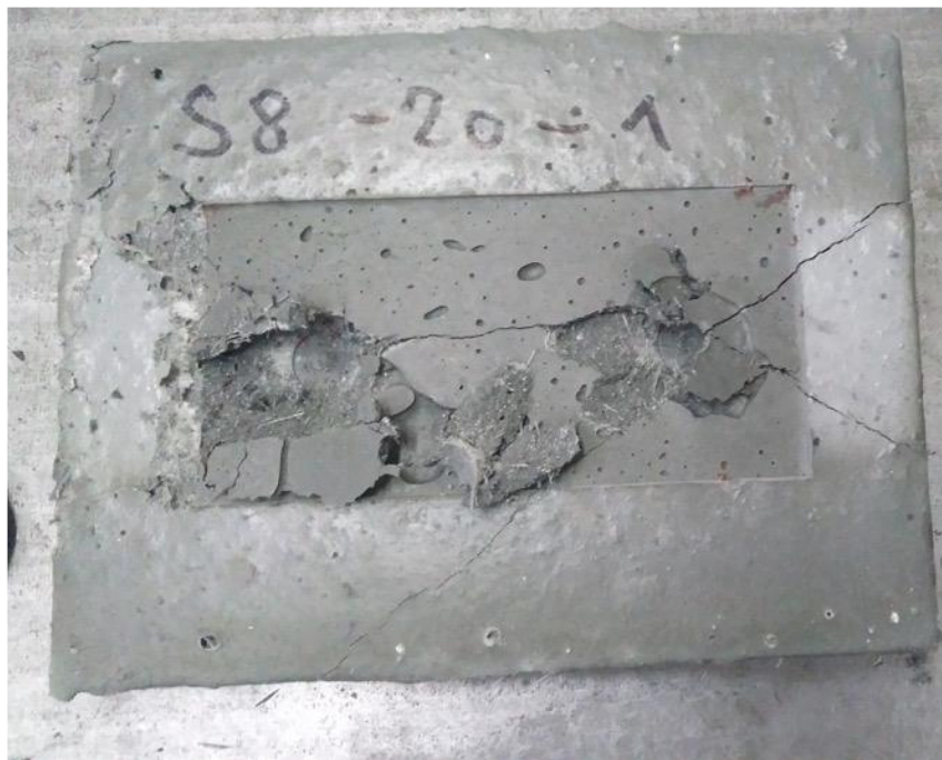
Obr. 54 Porušení vzorku po zkoušce smykové únosnosti dvojice kotev
