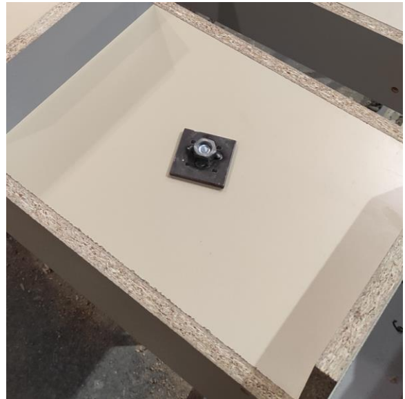
Obr. 62 Umístění kotvy na dně formy (F) a v horním povrchu (H)
