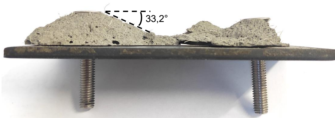
Obr. 45 Tvar vytrženého betonového kuželu u vzorků z HPFRC
