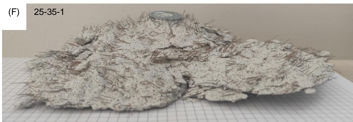
Obr. 83 Tvar vytrženého kuželu vzorku s kotvou v povrchu (F)
