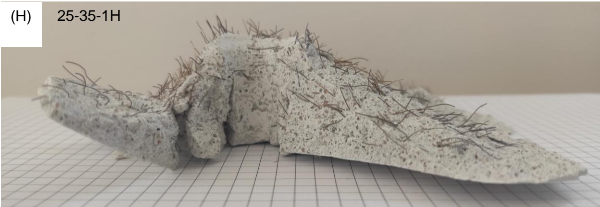
Obr. 84 Tvar vytrženého kuželu vzorku s kotvou v povrchu (H)
