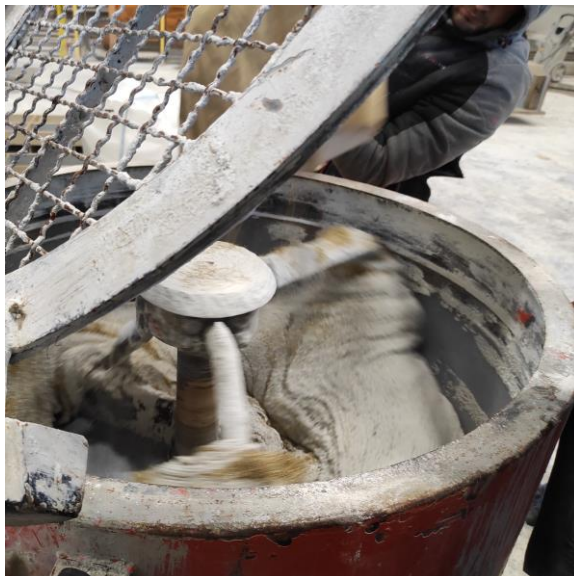
Obr. 63 Výroba první série vzorků z UHPFRC ( v_f = 1,5\% )
