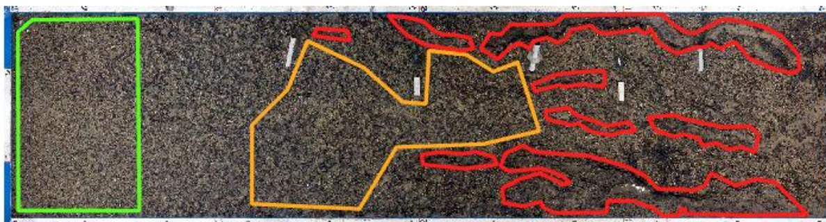
Obr. 25 Ukázka polygonů pro Laboratorní dešťový simulátor. Nepoškozený povrch – zelená, plošná eroze – oranžová, rýhy – červená
