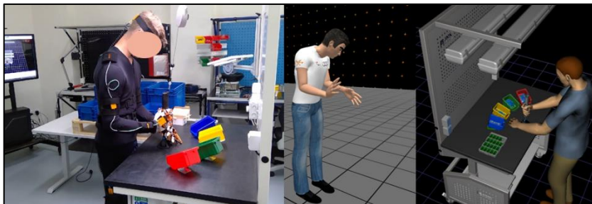
Obr. 12: Vybraná laboratorní úloha montáže (vlevo fyzická úloha, uprostřed s využitím Motion Capture, vpravo digitální dvojče v SW Siemens Tecnomatix Jack)
