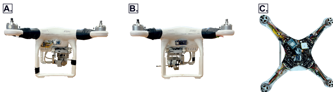
Obr. 3.14: Zabudovanie prototypu II pod kryt quadrokoptéry DJI Phantom 3 Standard. A: pohľad zprava; ovládací systém, modul snímača rýchlosti vzduchu a dva moduly s Hallovou sondou. B: pohľad zľava; mikrokontrolér Arduino RP2040, pitot - statická trubica na gimbele a dva moduly s Hallovou sondou. C: pohľad zhora; modul GY-87, modul NEO-6M s anténou a menič napätia pod hlavnou doskou plošných spojov quadrokoptéry.
