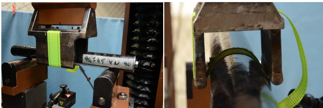
Obr. 43: Příklad zkoušeného vzorku a jeho uspořádání Obr. 44: Detail zatěžovacího členu zkušební soustavy ve zkoušecím stroji
