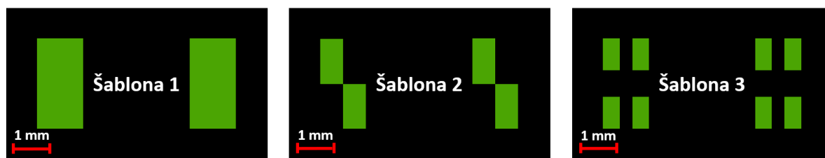
Obrázek 26 – Motiv použitých šablon pro nános pájecích past v Experimentu 1.
