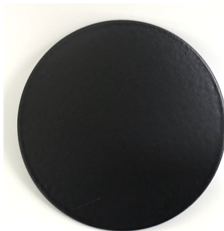
Obrázek 56 – Povlak epoxidové dvousložkové antistatické nátěrové hmoty LV EPS 620 s obsahem 2 hm. % vodivých sazí
