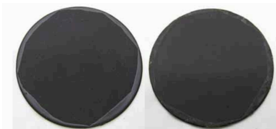
Obrázek 27 – Povlak LV EPS 620 obsahující 2 hm. % sazí – před (vlevo) a po (vpravo) korozní zkoušce oxidem siřičitým ve vlhké atmosféře, doba expozice 240 hod [9A]
