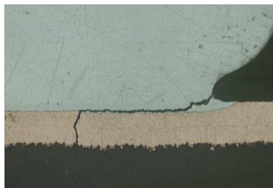
Obrázek 24 „Pad cratering“ s prasklinou vzniklou ve vodivé cestě. [158]
