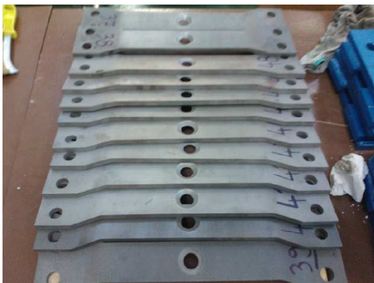
Obrázek 48 Vzorek typ 2 vzorky z ocele S355
