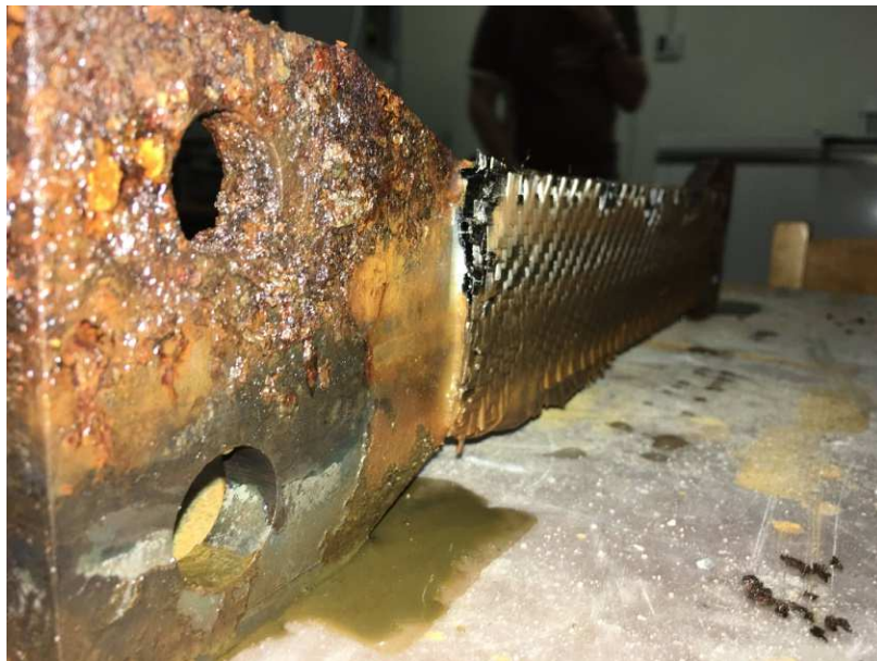
Obrázek 63 Vzorek 33 – po 1 roce cyklování ve slaném roztoku
