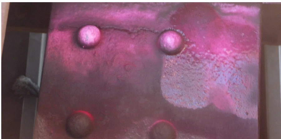
Obrázek 71 Únavová trhлина v horní pásnici nýtovaného nosníku – ilustrační obrázek
