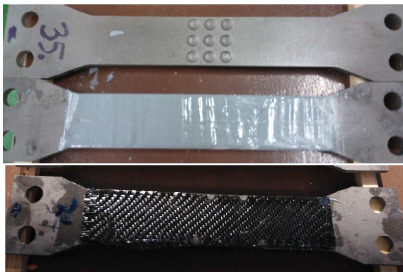
Obrázek 50 Tři stádia výroby zesílení – vzorek typ 1
