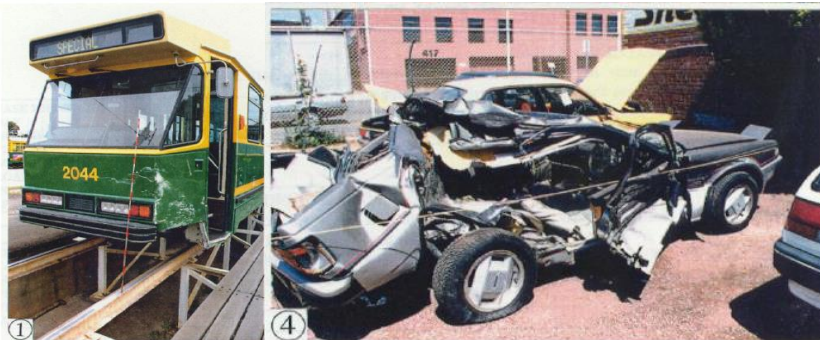
Obr. 1-2 Následek nárazu čela tramvaje do boku auta. [6]
