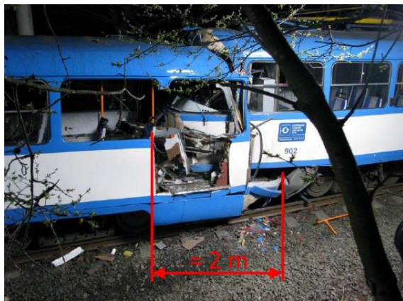
Obr. 2-18: Vyšplhání tramvají při nehodě. [66]
