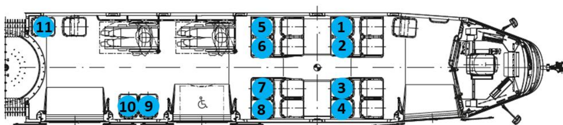
Obr. 4-33: Rozmístění cestujících v předním článku tramvaje typu B.
