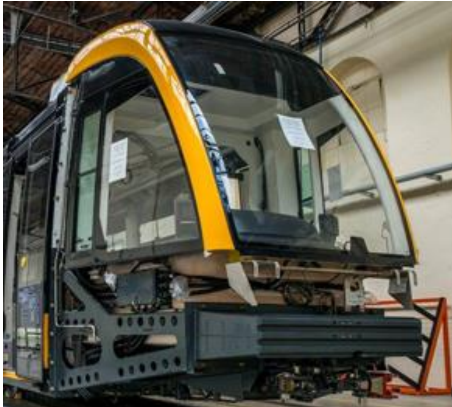
Obr. 2-15: Crush box na tramvaji Urbos 3 od firmy CAF, zdroj: behance.net/gallery .
