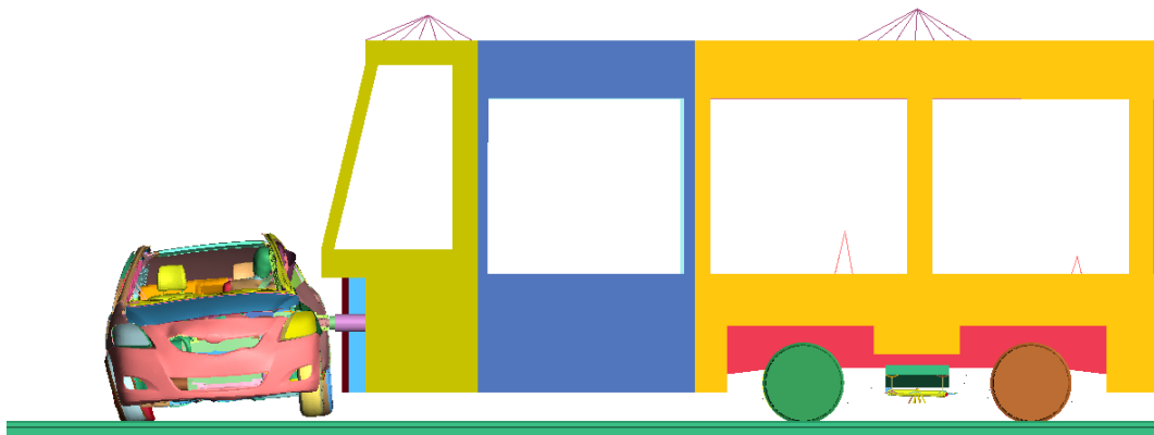
Obr. 4-51: Průběh nárazu komplexního modelu tramvaje typu B do boku auta při rychlosti 25 km/h v čase simulace: (a) 20 ms, (b) 40 ms, (c) 60 ms, (d) 80 ms.
