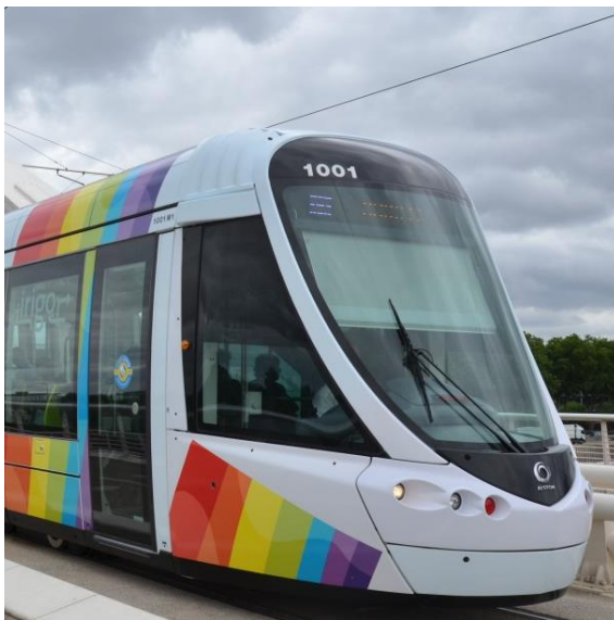
Obr. 2-23: Vhodný tvar čela tramvaje, zdroj: en.wikipedia.org .
