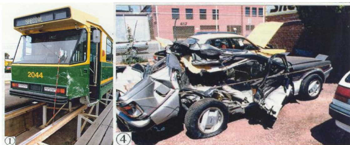
Obr. 2-5: Následek nárazu čela tramvaje do boku auta. [17]
