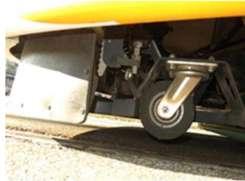
Obr. 2-22: Podjezdová ochrana, zdroj: hubner-group.com .
