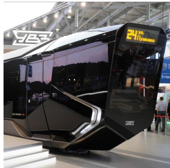
Obr. 2-24: Nevhodný tvar čela tramvaje, zdroj: trendhunter.com .
