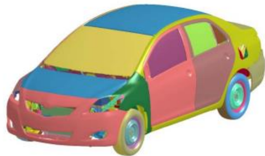
Obr. 2-65: Simulační model auta typu Toyota Yaris 2010. [58]
