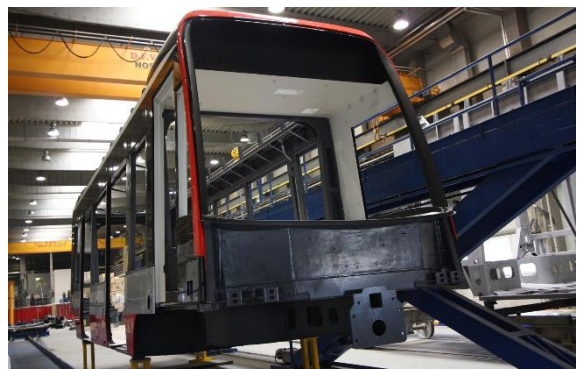
Obr. 4-9: Hrubá stavba předního článku tramvaje typu A, zdroj: idnes.cz/technet .
