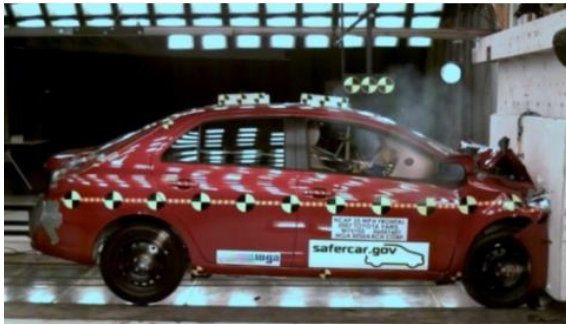
Obr. 2-66: Zkouška čelního nárazu. [59]
