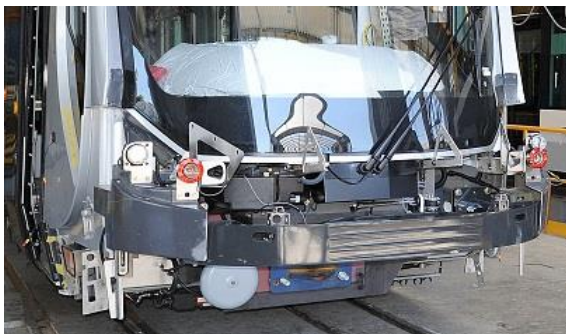
Obr. 2-13: Sestava nárazníku a dvou deformačních trubek, zdroj: vladan.foto.cz .
