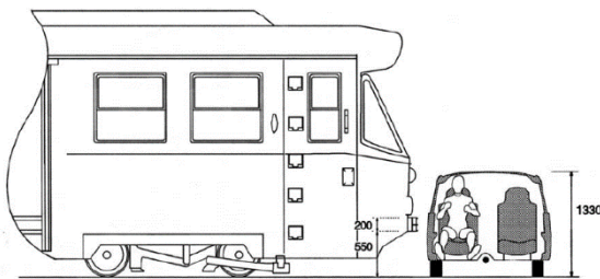
Obr. 2-3: Výškové umístění nárazníků na tramvajích. [17]
