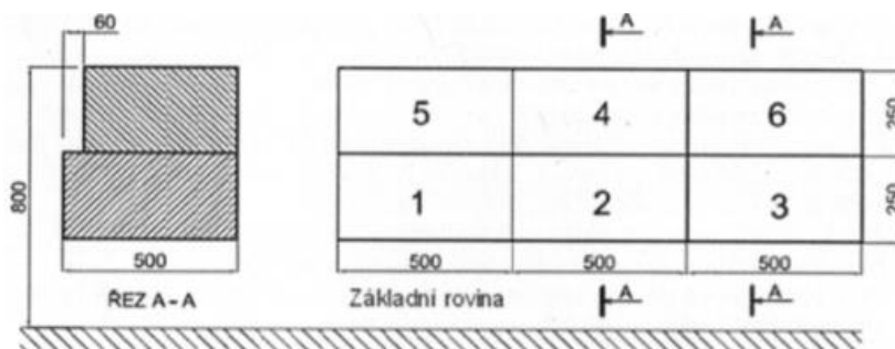
Obr. 2-44: Rozměry a tuhosti bariéry pro boční náraz. [22]
