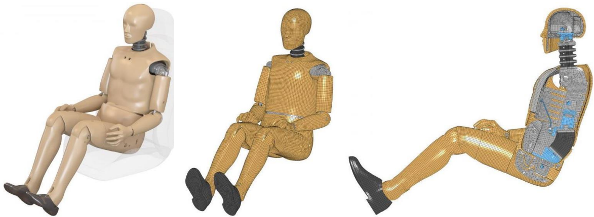
Obr. 2-55: Figurína Hybrid III: ATD a její výpočtový model. [68]
