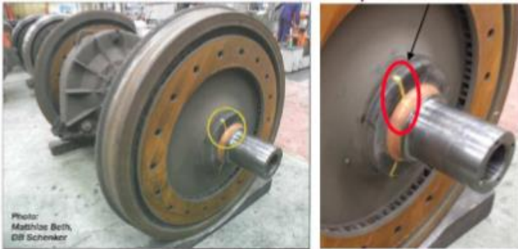
Obr. 6 Pootočení kola trakčního dvojkolí lokomotivy TRAXX. [8]
