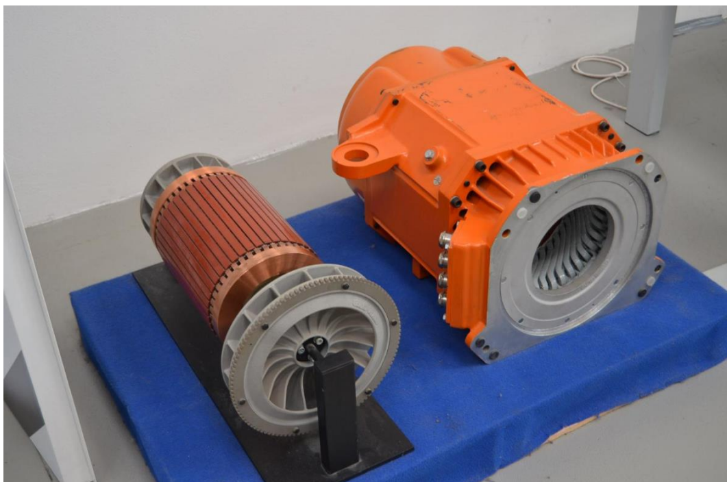
Obr. 2.7: Demontáž asynchronního motoru s kotvou na krátko. [5]
