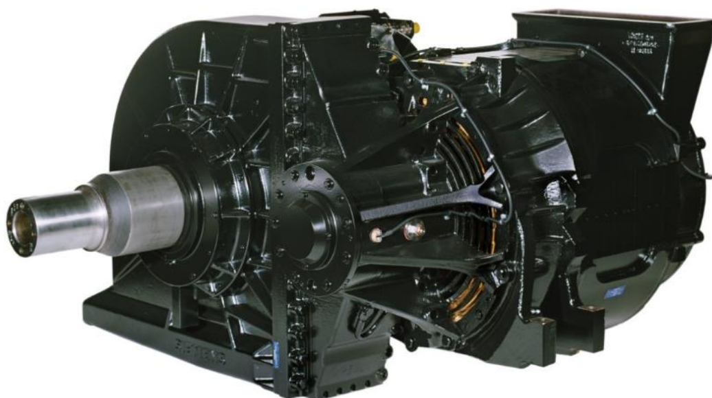
Obr. 2.16: Vizualizace tlapového pohonu lokomotivy. [4]
