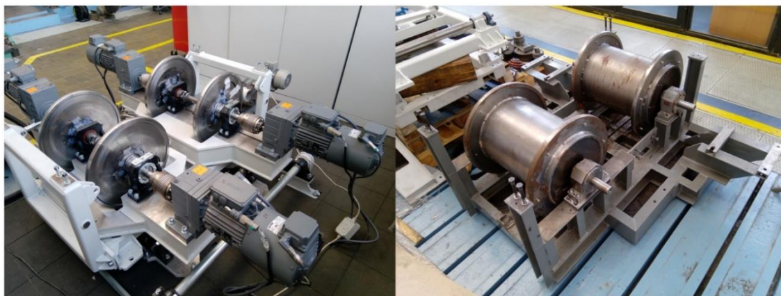
Obr. 5.2: Kladkový stav FS ČVUT – stanoviště č. 1 (vlevo); stanoviště č. 2 (vpravo) [41]
