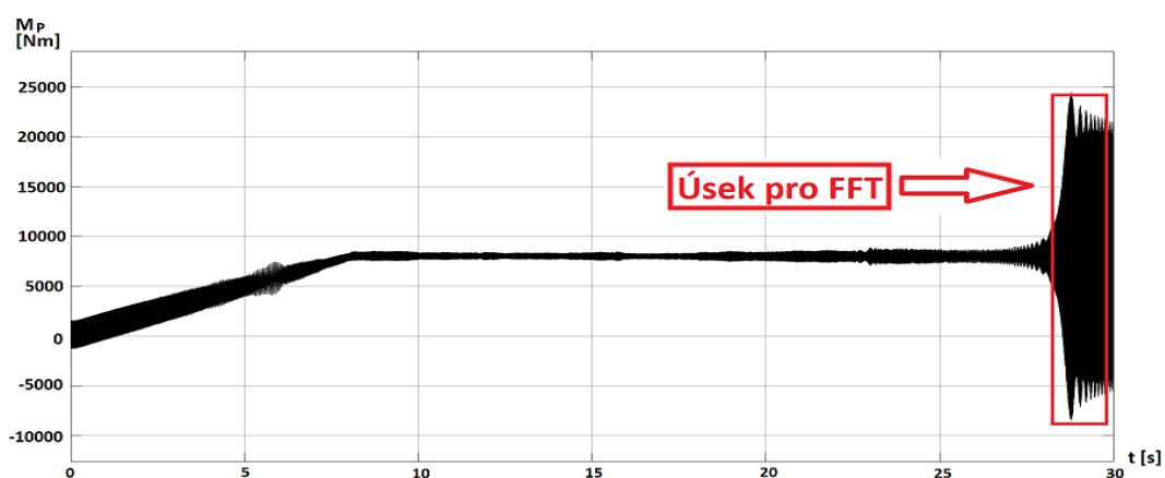
Obr. 4.35: Průběh signálu hnacího momentu pastorku pro k_{R2} .
