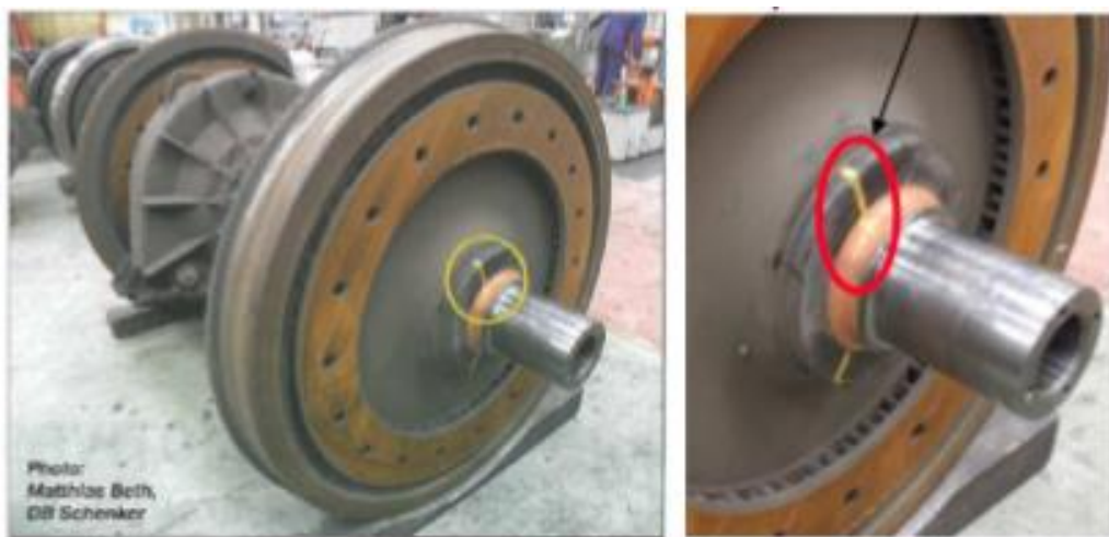
Obr. 2.22: Pootočení kola trakčního dvojkolí lokomotivy TRAXX. [17]
