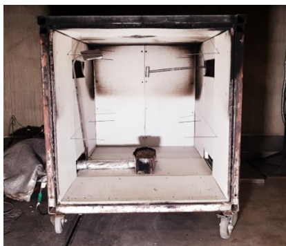
Obrázek 25 Malá zkušební pec miniFUR (UCEEB) [44]
