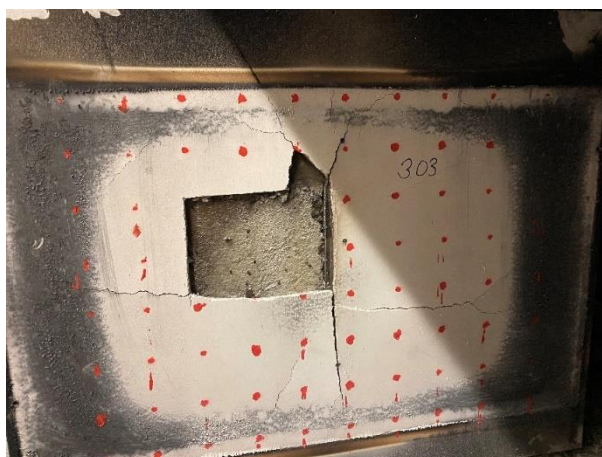
Obrázek 70 Vzorek 06 s označením míst měření kalcinace
