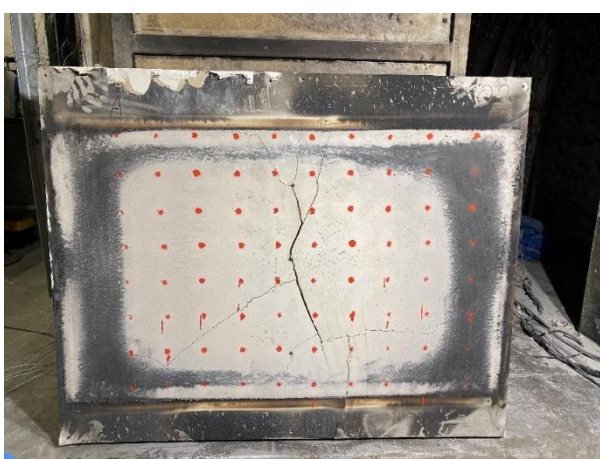
Obrázek 66 Vzorek 02 s označením míst měření kalcinace
