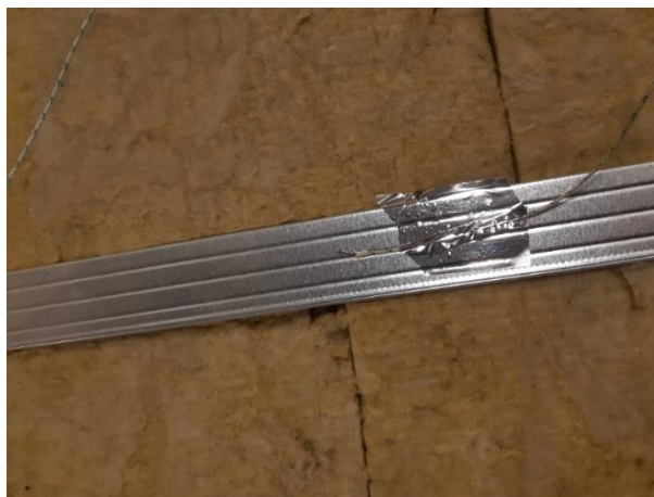
Obrázek 45 Detail umístění termočlánku – na středovém profilu CW
