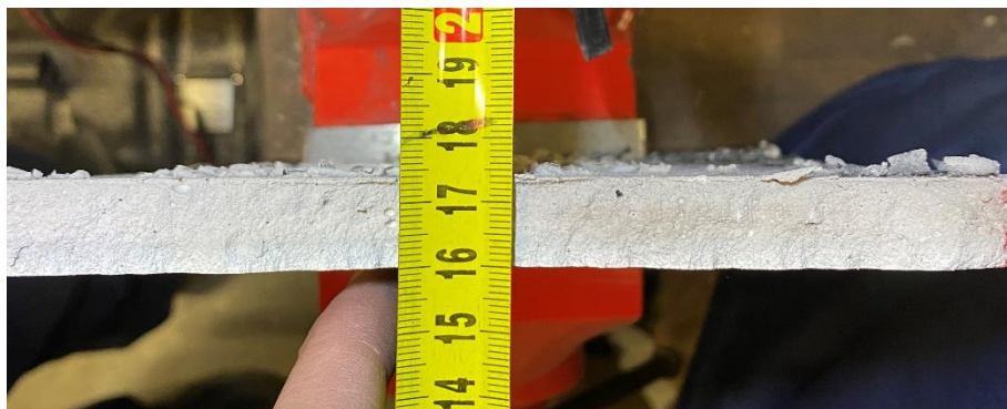
Obrázek 77 Příčný řez deskou vzorku 01 s patrnou čarou kalcinace
