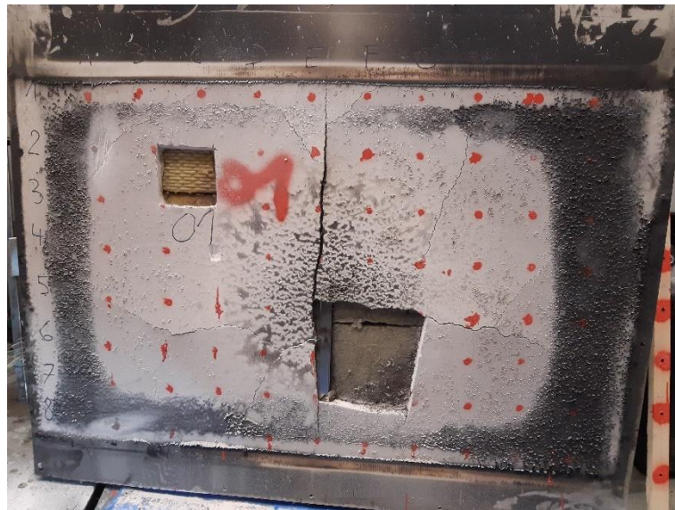
Obrázek 76 Odebraný kus ze vzorku 01 pro měření kalcinace v řezu deskou (část vpravo dole)
