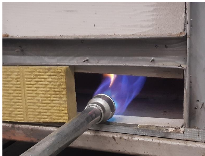
Obrázek 29 Předmíchaný plamen - proudový hořák
