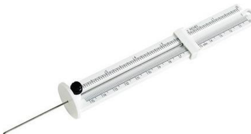
Obrázek 22 Hloubkoměr pro měření hloubky kalcinace [16]
