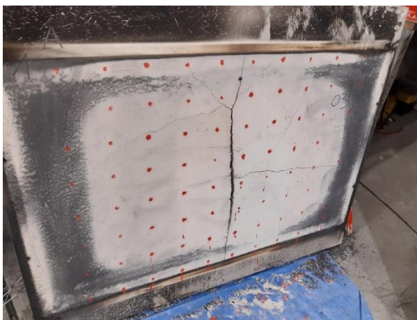
Obrázek 67 Vzorek 03 s označením míst měření kalcinace
