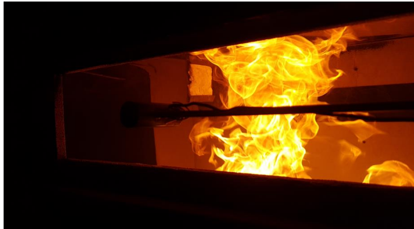
Obrázek 27 Difúzní plamen - pískový hořák [44]
