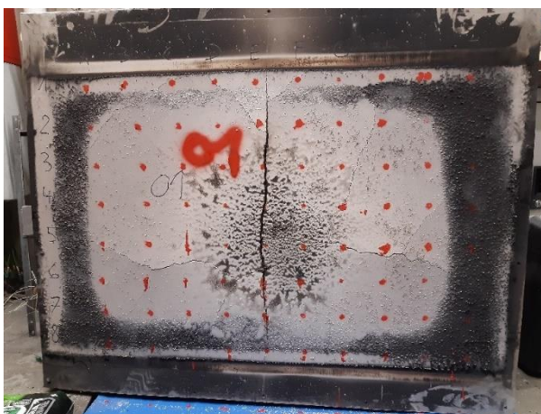
Obrázek 65 Vzorek 01 s označením míst měření kalcinace
